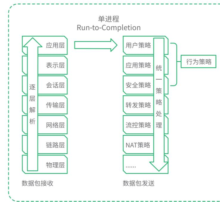
一体化报文处理引擎配合智能分流器，在单个处理核的处理进程上完成从报文接收、报文解析、策略控制、报文发送的所有工作。一次解析，统一处理，避免了多模块、多进程之间的重复工作和报文拷贝。在策略统一处理时，还可基于用户策略、应用策略、安全策略等，进行更高层次的抽象，制定基于基础策略的高级策略。
